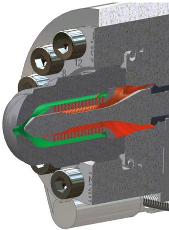
Saubere, fremdpartikelfreie Schmelzen sind die Voraussetzung für eine störungsfreie, wirtschaftliche Produktion von Spritzgussteilen. Nur minimal grössere Fremdpartikel verstopfen den Teileanspritzkanal im Heisskanal.
